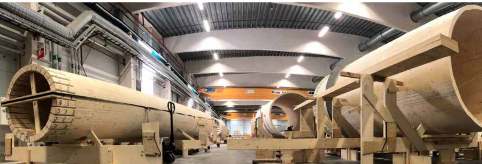
Windräder aus Holz bestehen aus Einzelringen, die erst vor Ort zusammengebaut werden müssen
